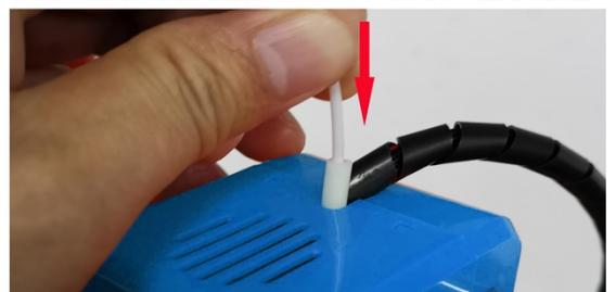
**进不了料原因:** 1 耗材前端没弄直, 2 是没有一直用点力压住耗材
