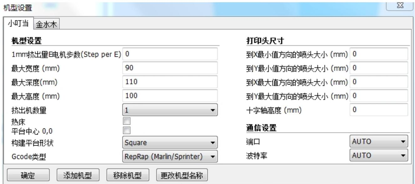
5、选择打印机连接电脑后生成的端口以及波特率 115200，点击“确定”
